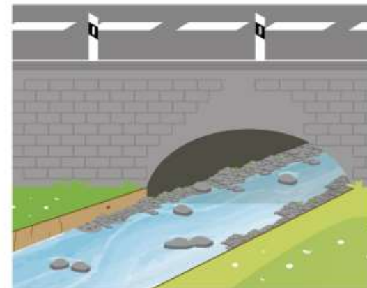
Nachher: Breiter Durchlass mit durchgängiger Sohle und durchwanderbaren Uferbermen.
